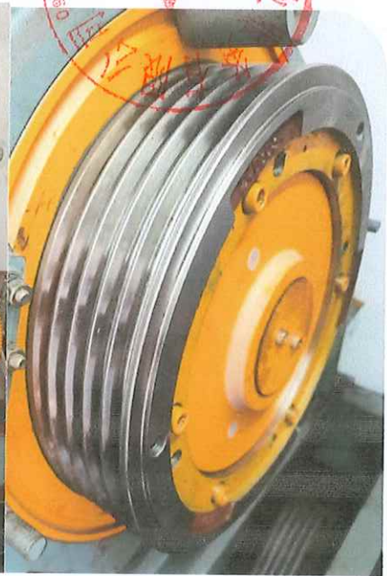
电梯曳引轮更换后
