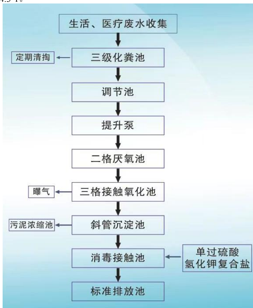
图 4.3-1 项目污水处理系统工艺流程
